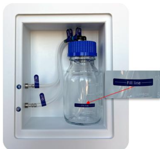
Rysunek 21.1 Podłączanie rurek do butli do nawilżania i wielostrefowej stacji roboczej ART
